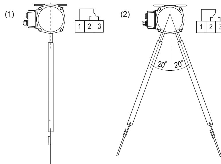
1. В свободном состоянии ось штанги с лопаткой располагается вертикально, замкнуты контакты 1 и 3 микровыключателя.
