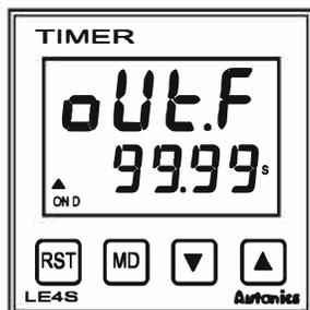
• "oU.F" - символьная индикация режима выхода на ЖК-дисплее. Отображается постоянно, пока производится выбор режима работы выхода.
