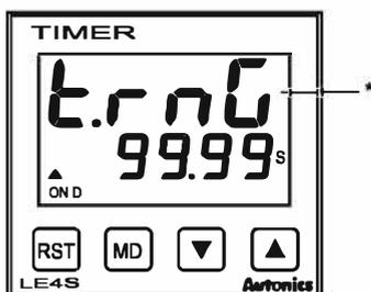
\* t.r.n.G - символическая индикация диапазона времени на ЖК-дисплее. Отображается постоянно, пока производится выбор диапазона времени.
