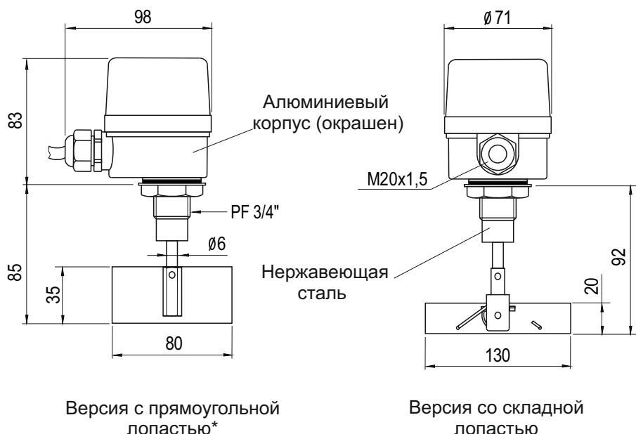
\*Монтаж лопасти осуществляется изнутри бункера, либо через переходной фланец (изготавливается заказчиком самостоятельно)
