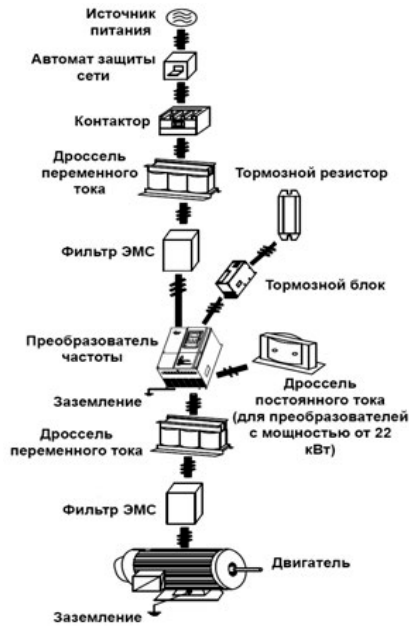
Рис. 1-2. Подключение преобразователя частоты
