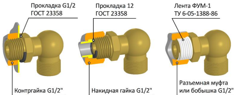
Рисунок 8.2 – Способы уплотнения присоединительной резьбы
