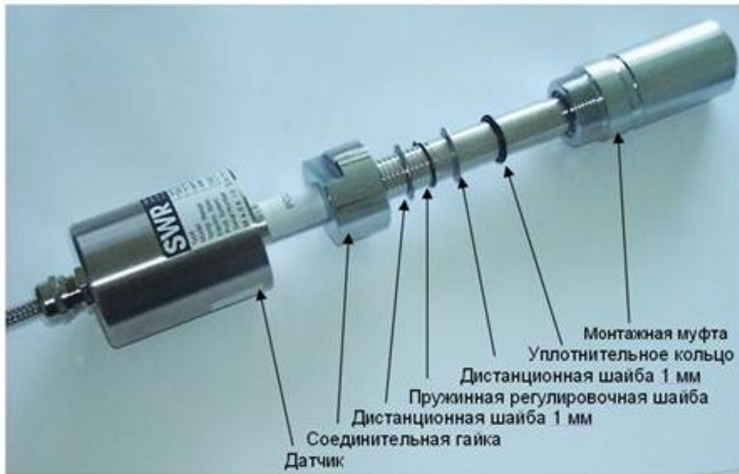
Рис. 6а. Монтаж sensor accommodation и сенсора.
