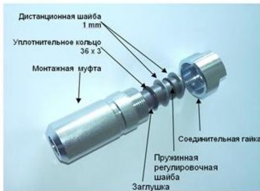
Рис. 5. Установка монтажной муфты и заглушки.
