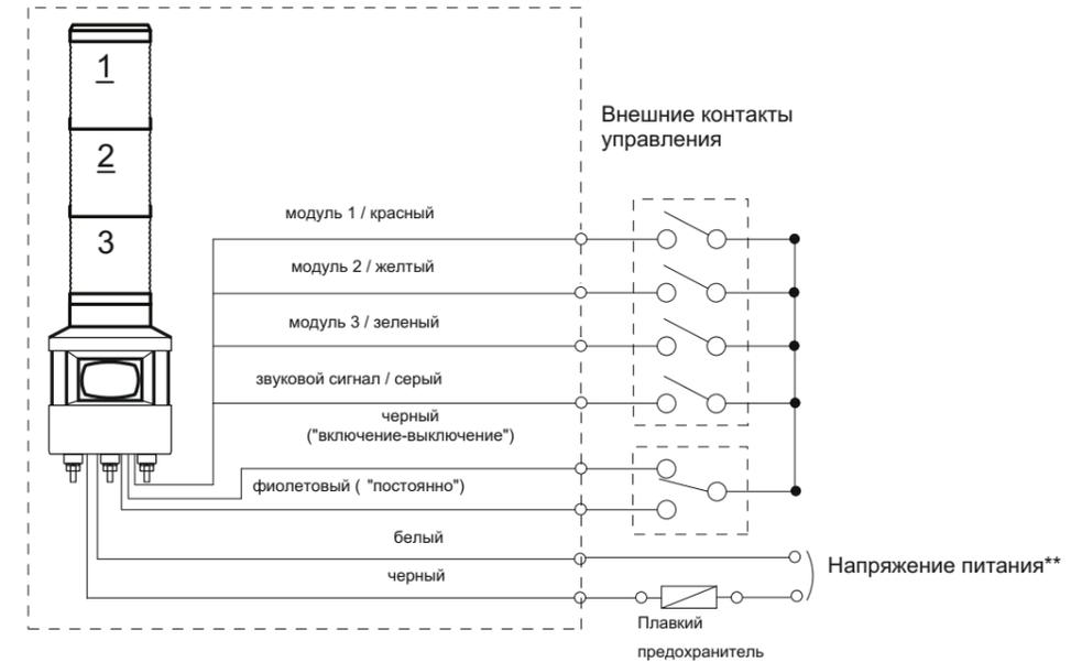
Электрические провода напряжения питания имеют большее сечение, чем провода управления.
