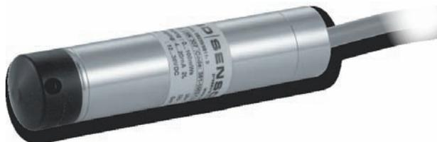
Погружной зонд диаметром 27 мм с керамическим сенсором, предназначен для непрерывного измерения уровня жидкостей, неагрессивных к нержавеющей стали.
