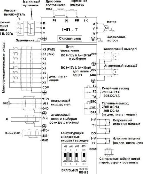
**Категорически запрещается подсоединять питающее напряжение к выходным клеммам U V W.**
