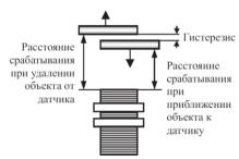
Для всех коммутирующих датчиков необходим гистерезис для устранения дребезга выходов. У индуктивных выключателей гистерезис получается от разности рабочих расстояний до объекта при приближении и удалении измерительной пластины и составляет ок. 10% от номинального расстояния срабатывания.
