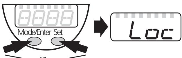
Во время эксплуатации: [Loc] кратко отображается на дисплее при попытке внесения изменений в значения параметров.
