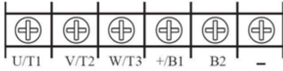
Тип корпуса 4. Трехфазные, 380 В, мощностью от 15 кВт до 22 кВт:
