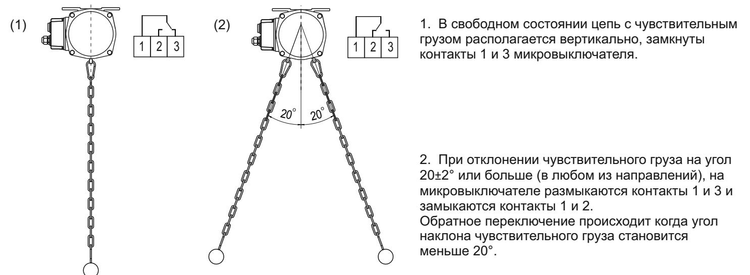
1. В свободном состоянии цепь с чувствительным грузом располагается вертикально, замкнуты контакты 1 и 3 микровыключателя.
