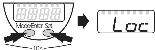
Во время эксплуатации: [Loc] кратко отображается при попытке внесения изменений в значения параметров.
