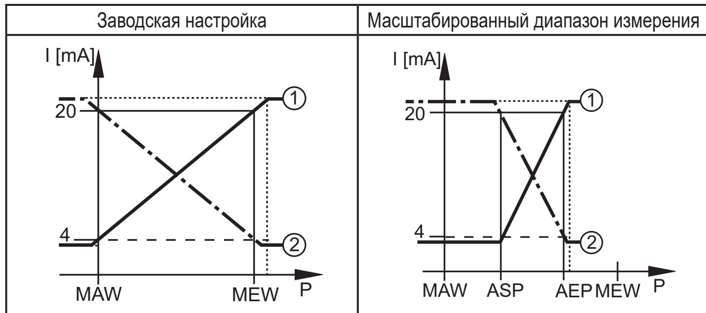
$P$  = давление в системе,  $MAW$  = начальное значение диапазона измерения,  $MEW$  = конечное значение диапазона измерения
