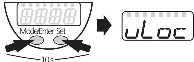
Заводская настройка прибора: в незаблокированном состоянии.
