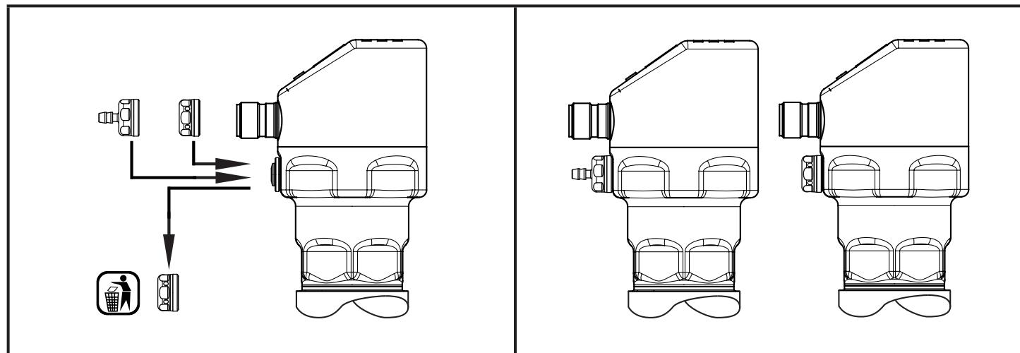
**!** Когда используется закрытая крышка, измерение может отклоняться из-за колебаний атмосферного давления и колебаний давления внутри прибора (так как нет компенсации измерительной ячейки на окружающую среду) ( $\Delta 10 \text{ K} \leq 30 \text{ мбар}$ ).
