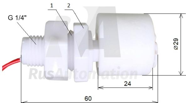
1 - уплотнительное кольцо, высота 1,8 мм, внутренний диаметр 9,6 мм
