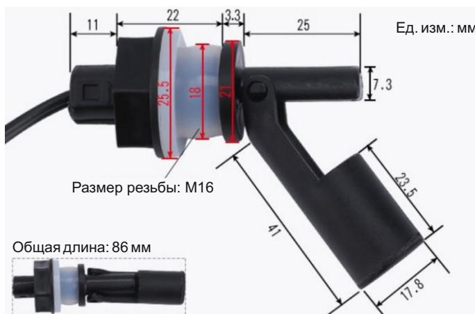
При убывании уровня все происходит в обратном порядке. Крепеж осуществляют через стенку емкости, поэтому все сигнализаторы имеют уплотнительную прокладку и фиксирующую гайку. Электрическое подключение к датчику выполняется через свободный конец кабеля.
