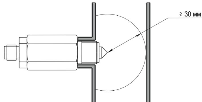
Длина штуцерного ввода должна быть подобрана таким образом, чтобы конус датчика выступал за край емкости.
