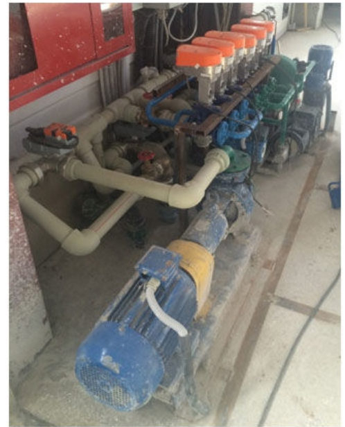
Рис.1. Стенд гидравлических и пневматических испытаний
